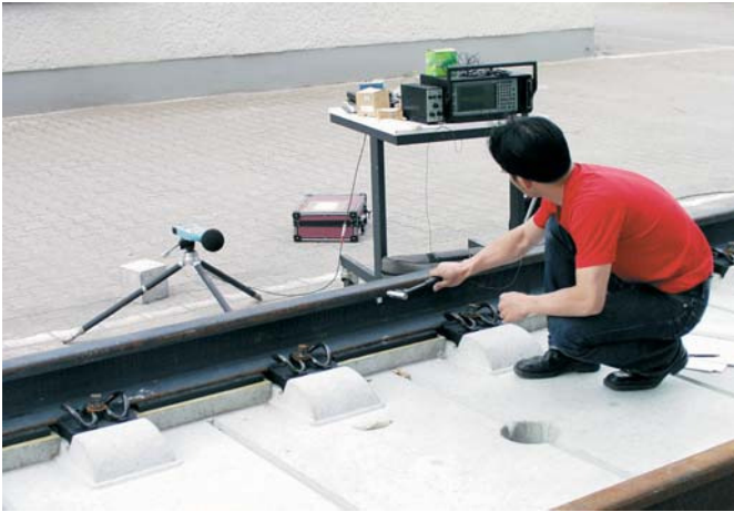
Hammeranregung Kontilager: Auf der Freifläche des Fachgebietes wurden 2004 Schalluntersuchungen mit einer kontinuierlichen Lagerung einer Festen Fahrbahn des Herstellers Max Bögl durchgeführt. Foto: Reinhold Wassmann.
